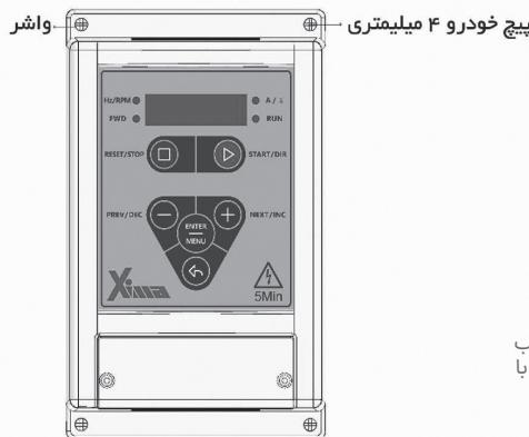
شکل ۱۴ نمایش نصب دستگاه به صورت تراز با سطح افق
